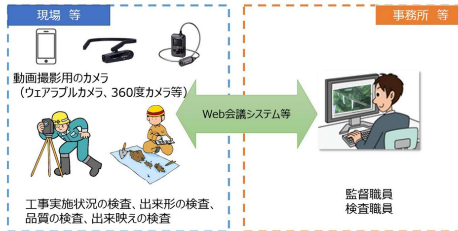
遠隔臨場による工事検査に使用する機器構成
