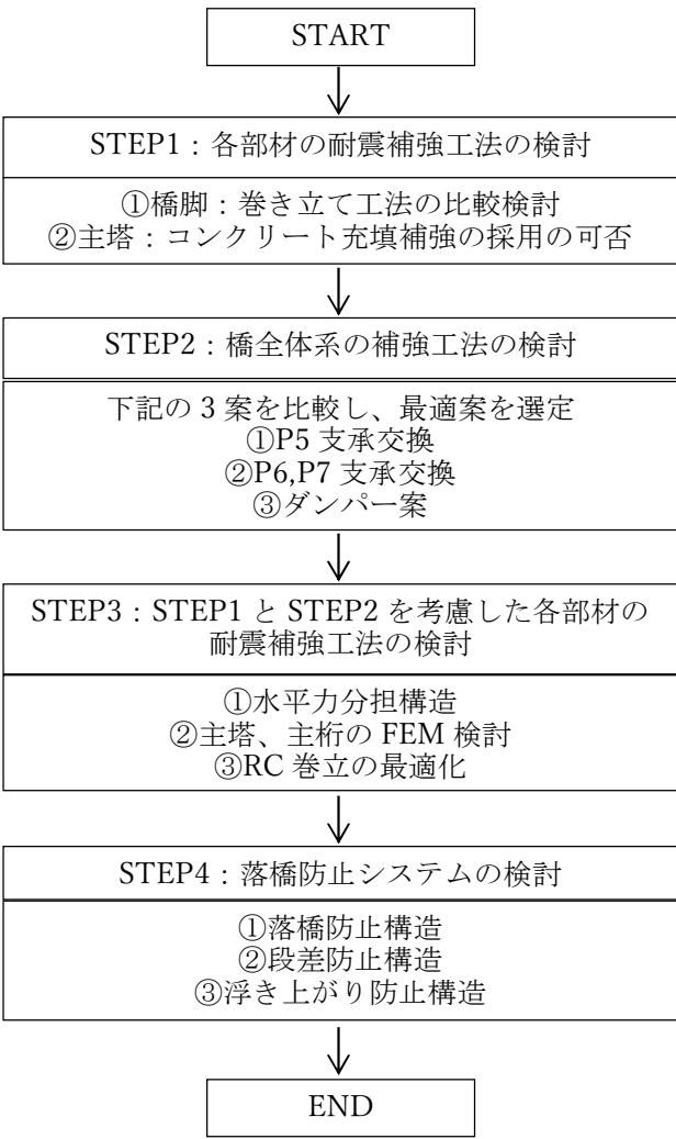
図 2.1 耐震補強検討フロー
